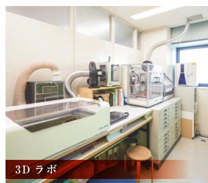
3Dスキャナ、3Dプリンター、レーザー加工機が並び、イメージ通りの作品制作をサポートします。
